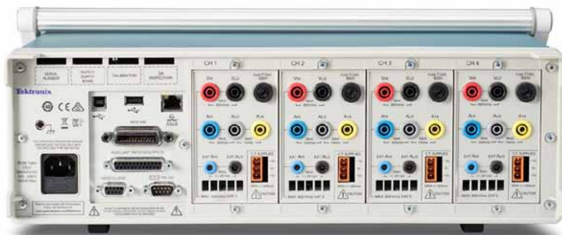
PA3000 后面板，拥有四条输入通道和选配的 GPIB 接口
