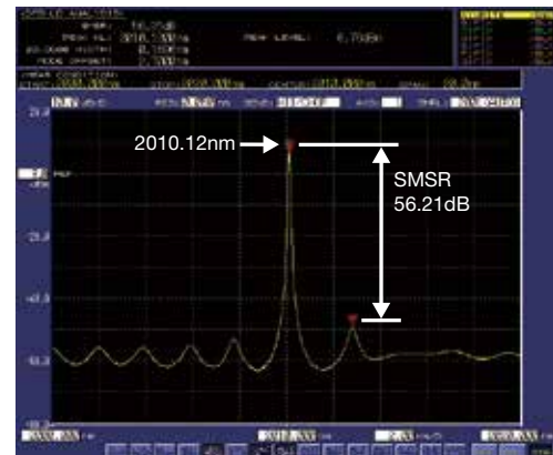
针对2010nm DFB-LD的测量实例 (分辨率: 0.05nm, 跨度: 20nm)
